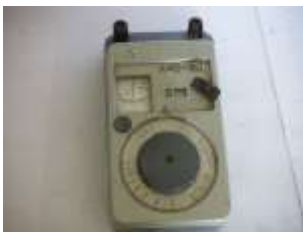
078 Cèl·lula de calibratge, patró de voltatge. Any 45 aprox.
