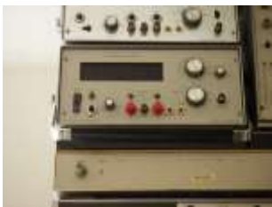
063 HP MULTIPLEXO, fins a 8 canals connectats i commutables
